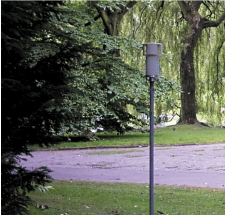
Sigma-Depositionssammler, aufgestellt in der Mitte des Essener Stadtgartens zur Ermittlung der trockenen Schadstoffdeposition. Foto: AG Klimaforschung
